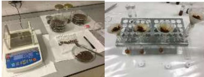
8.4 Anexo N°3. Imagen de la determinación del compuesto fenólico en el kit Test en cubetas fenol.
