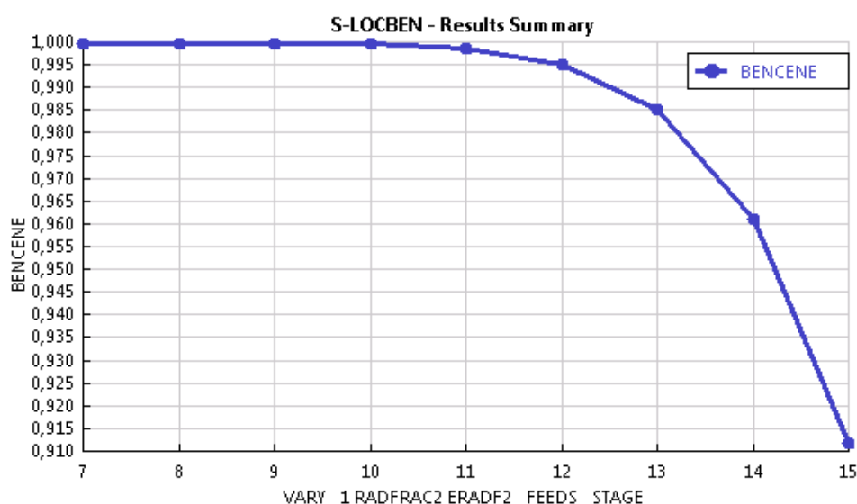
Figura 34: Fracción molar de benceno obtenida en la parte superior de la columna frente a la ubicación de la bandeja de alimentación.
