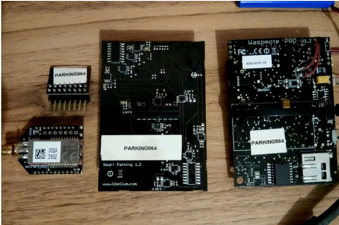
Figura 5.41: Partes del sensor con el mismo ID y módulo Sigfox correspondiente al visualizado en las imágenes del Backend de Sigfox.
