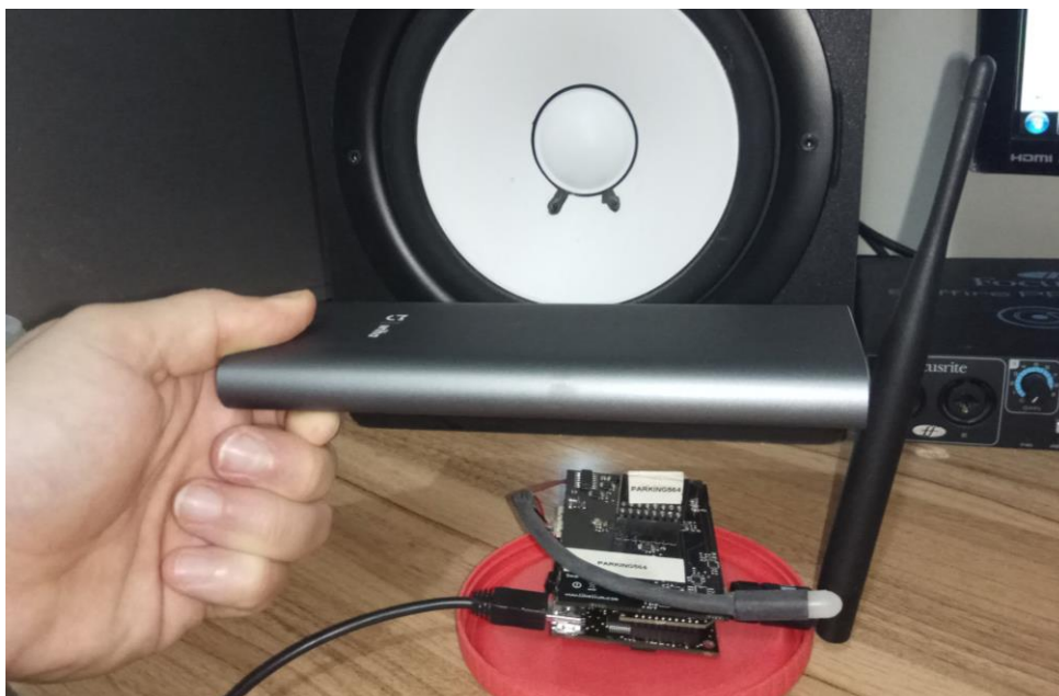
Figura 5.43: Se utiliza un objeto metálico en sustitución de un automóvil.
