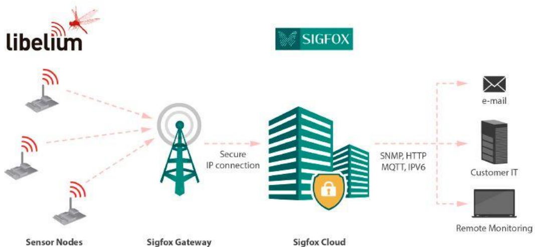
Figura 2.4 Esquema de Red Sigfox - Libelium
