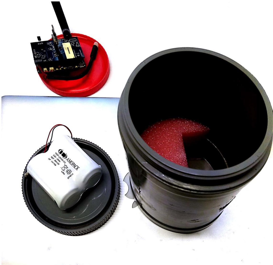
Figura 5.42: Equipo completo preparado para la inserción en la calzada.
