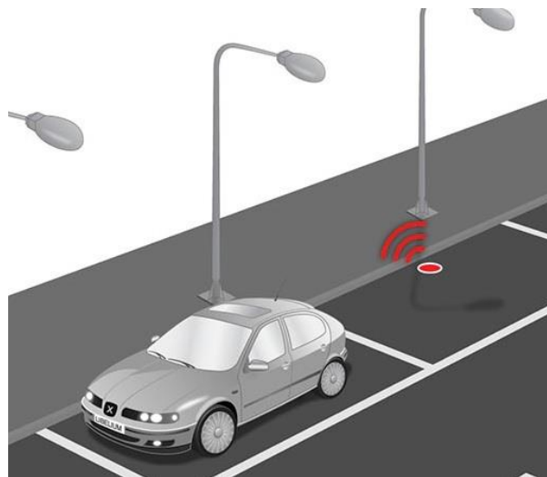
Figura 2.2 Sensor detectando plaza ocupada.
