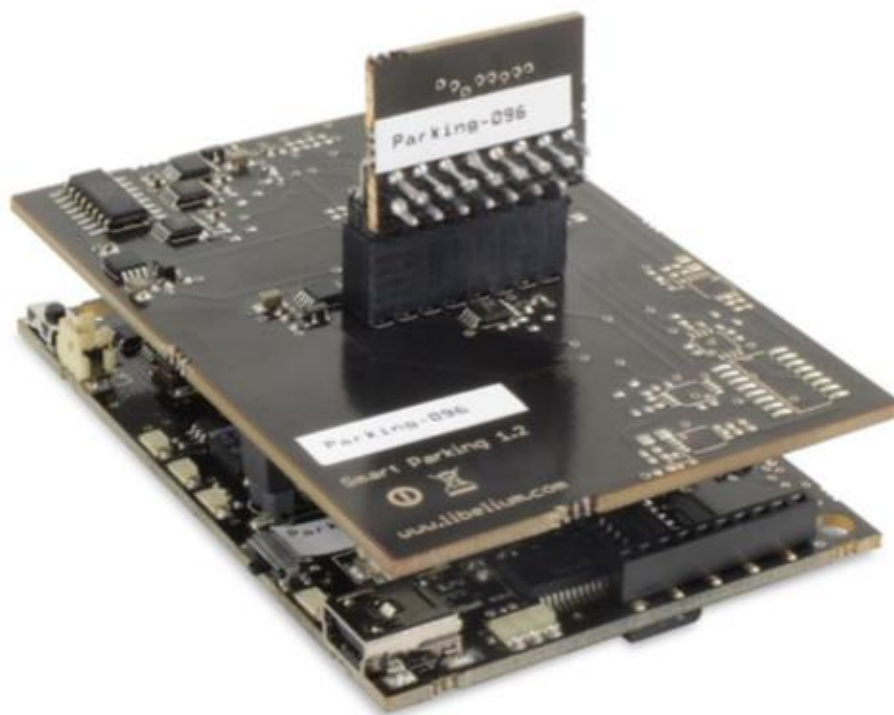
Figura 4.17: Sensor de Parking montado en placa Waspote
