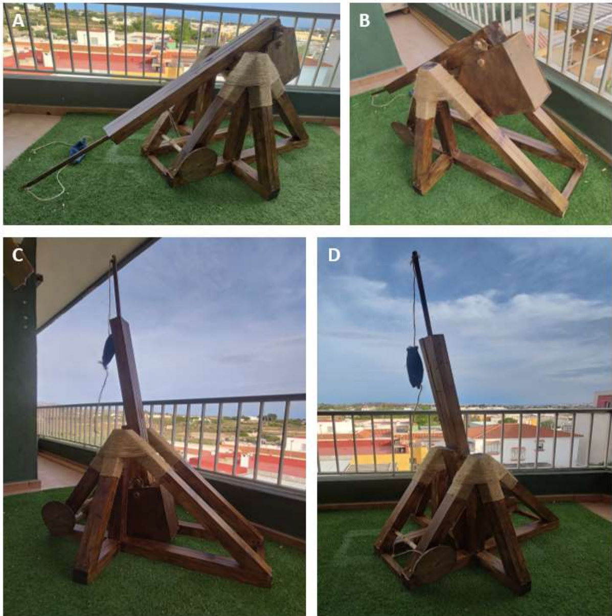
Figura 36: Modelo terminado. A: Parte delantera en posición de disparo; B: Parte trasera en posición de disparo; C: Parte trasera tras el disparo; D: Parte delantera tras el disparo.
