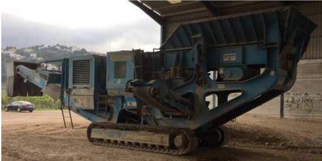
Figura 15. Fotografía del equipo de trituración primaria.
