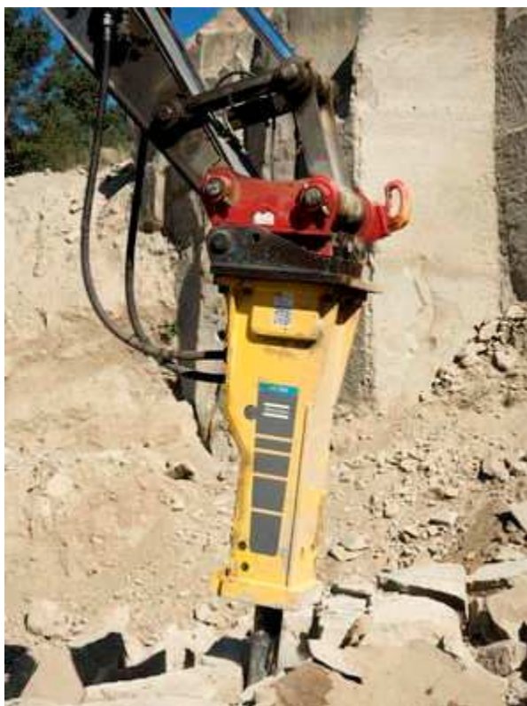
Figura 12. Fotografía del martillo percutor.
