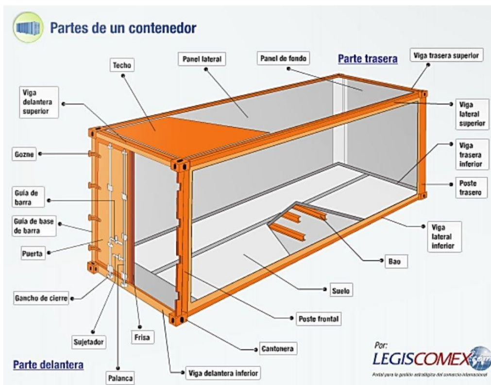
Figura 8. Partes de un contenedor marítimo
