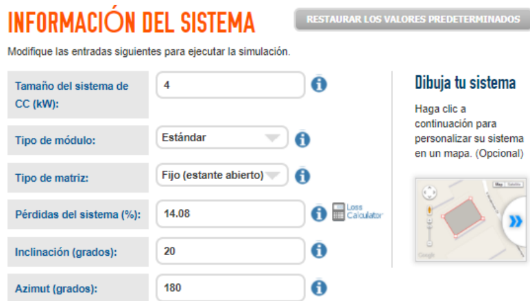
Ilustración 15.- Datos de entrada de PVWATTS.
