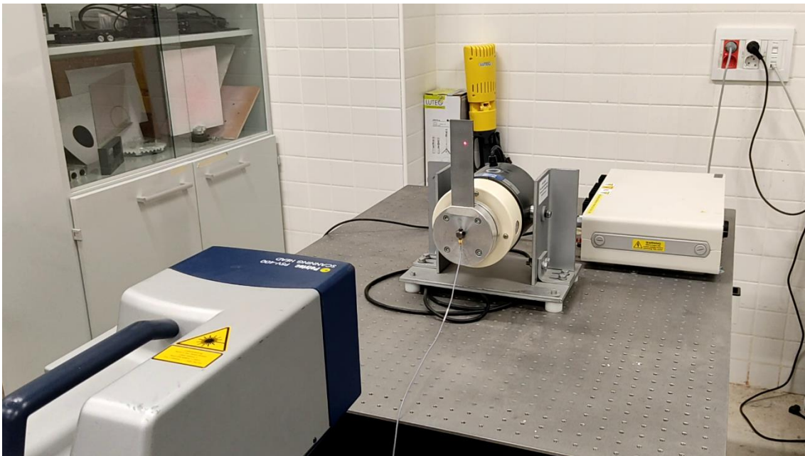
Figura 36 - Vibrómetro, shaker, probeta y amplificador
