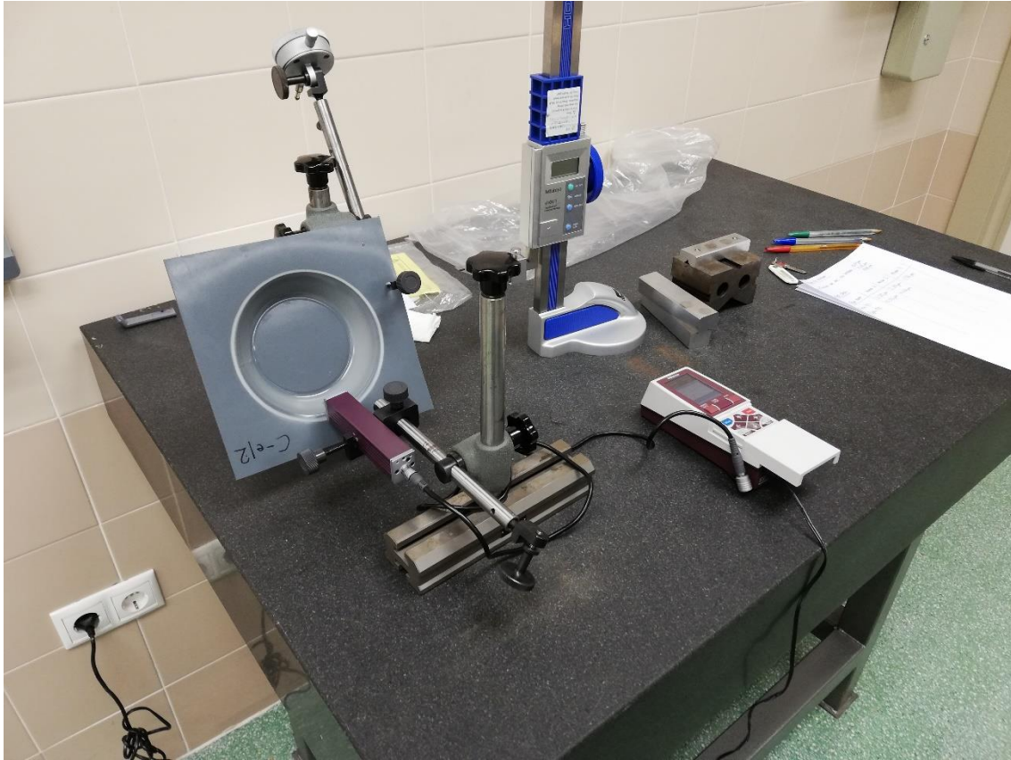
Ilustración 2.24 Esquema de medición de rugosidad
