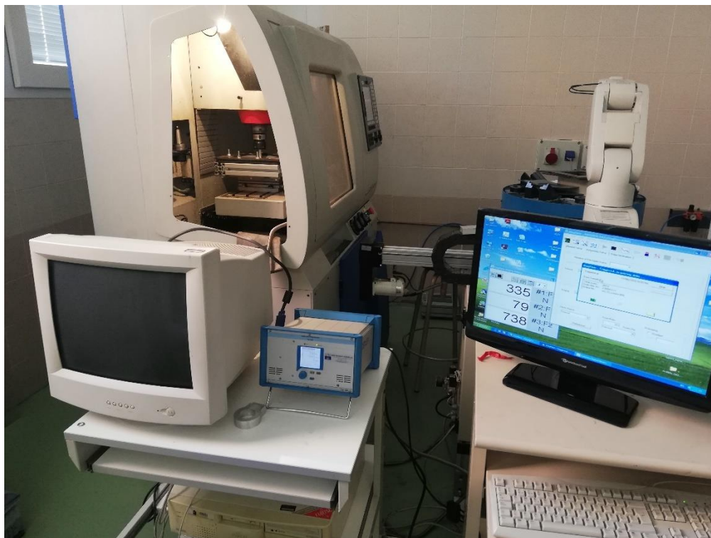
Ilustración 2.23 Montaje completo para la realización del SPIF
