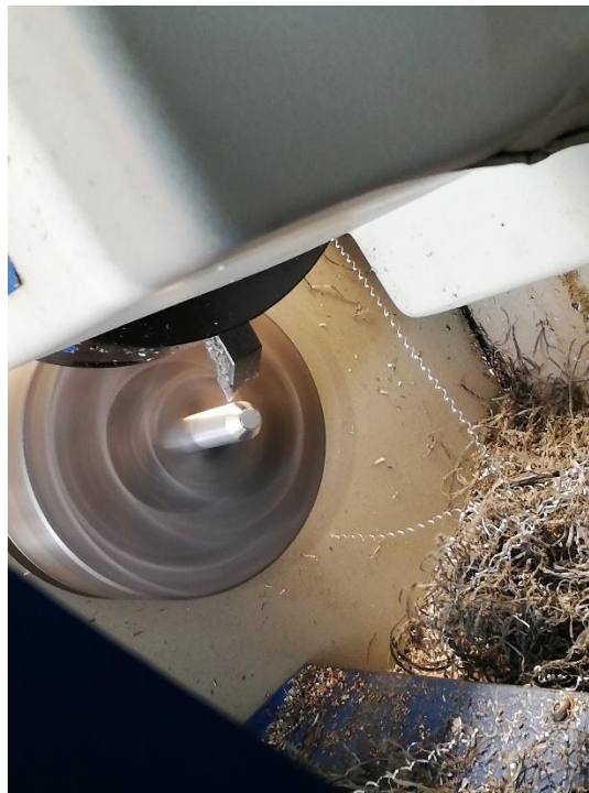
Ilustración 3.21 Fabricación de las puntas en torno CNC
