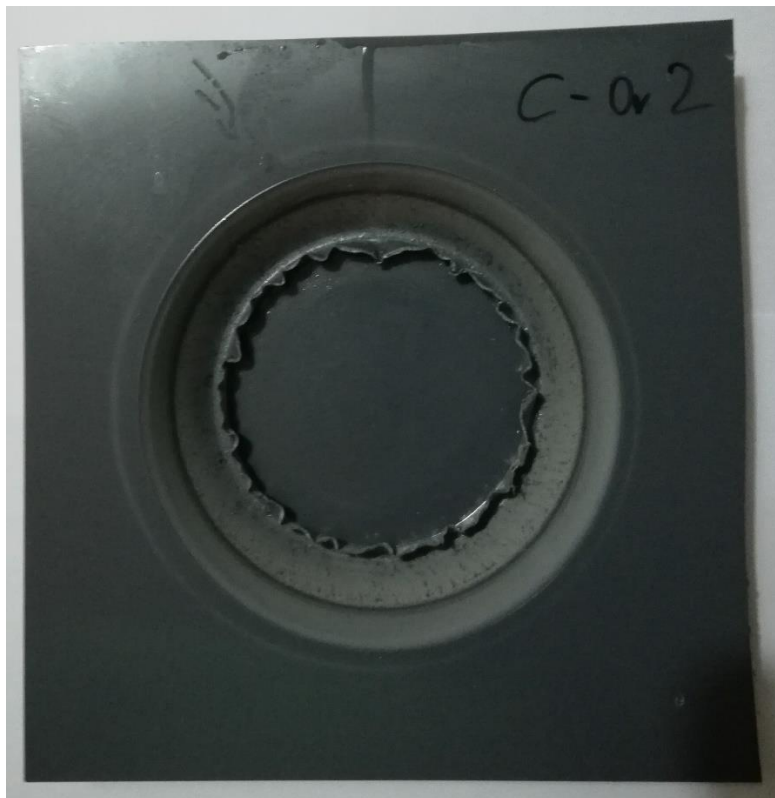
Ilustración 3.30 Resultado ensayo punta ovoide radio 2 mm
