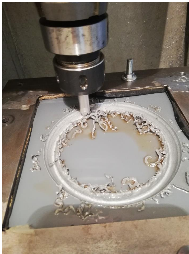
Ilustración 3.31 Realización del ensayo con punta cónica
