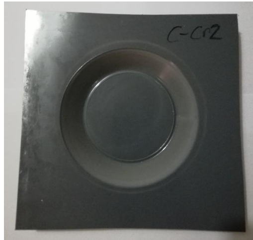
Ilustración 3.32 Resultado ensayo punta cónica radio 2 mm
