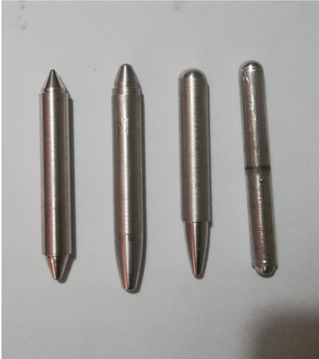
Ilustración 3.22 Diferentes puntas fabricadas para los ensayos
