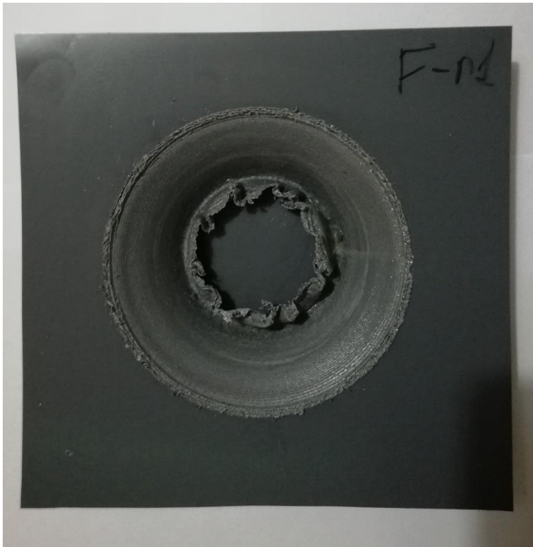
Ilustración 3.29 Resultado ensayo con punta cónica radio 1 mm
