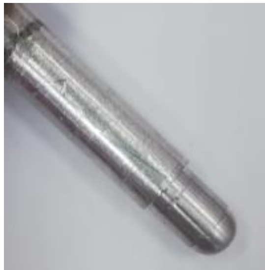
Ilustración 3.34 Restauración de la punta esférica de 8 mm
