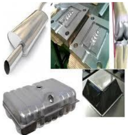
Ilustración 1.6 Aplicaciones del conformado incremental
