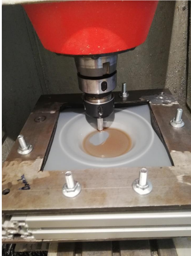
Ilustración 3.24 Realización de un frustrum con la punta esférica
