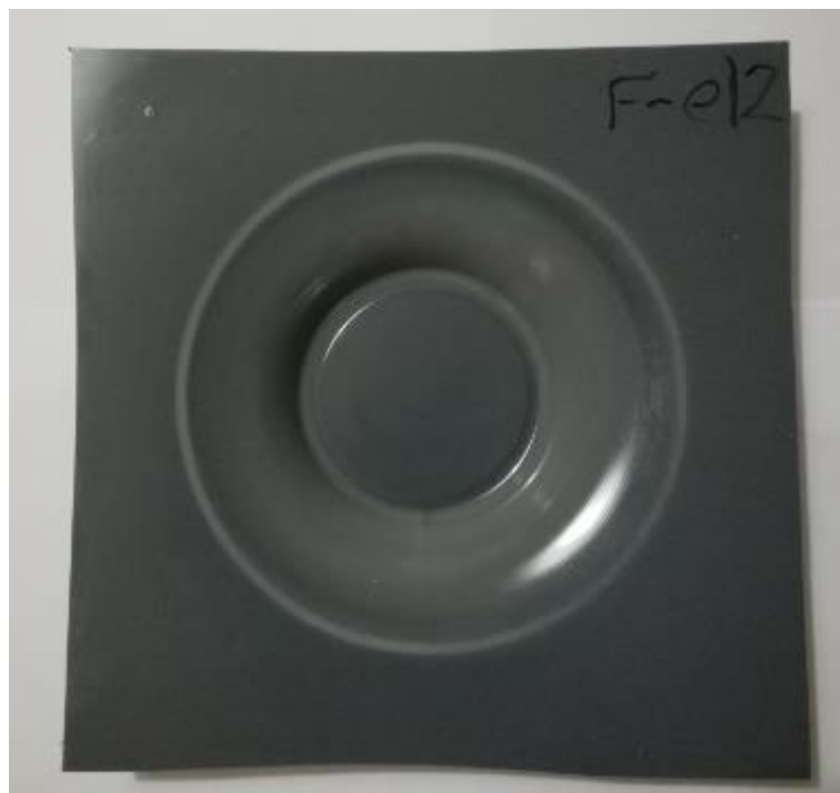
Ilustración 3.27 Geometría de un frustrum obtenida con la punta esférica 12
