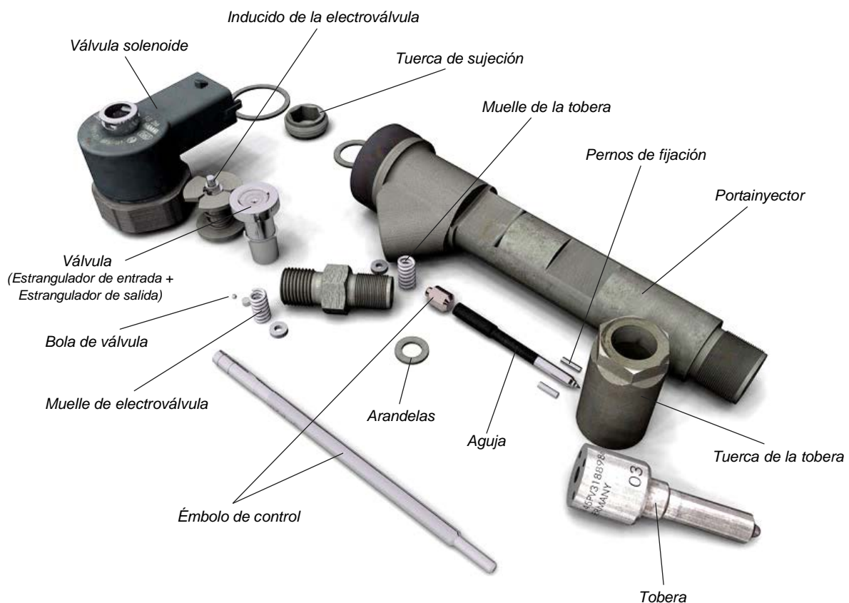
FIGURA 1.18 Despiece del inyector de válvula solenoide
