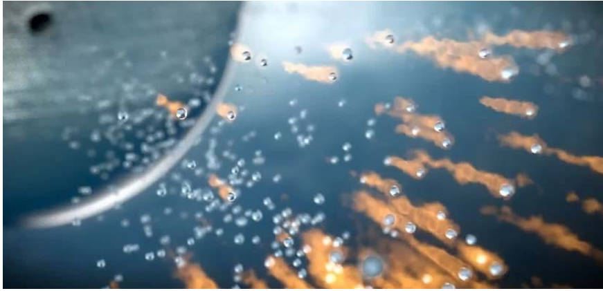
FIGURA 1.23 Pulverización del combustible insuflado (Fuente: Bosch)
