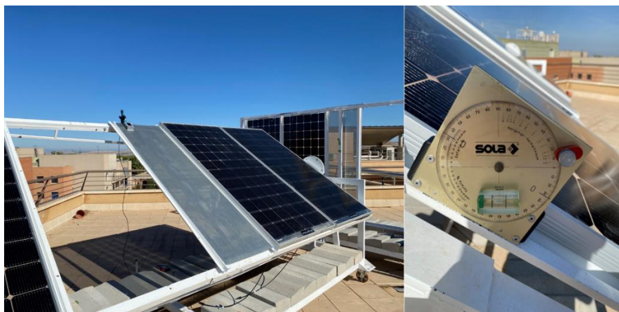
Figura 11. Módulos fotovoltaicos orientados al sur e inclinados 33 grados para su correcta caracterización.
