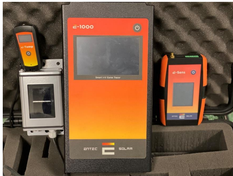
Figura 10. Trazador de curvas E-1000 y dispositivos complementarios E-Temp, E-Sens y célula calibrada.
