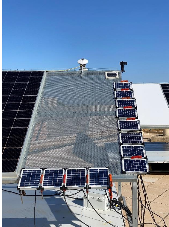
Figura 65. Campaña de calibración de las células solares Enjoy Solar.
