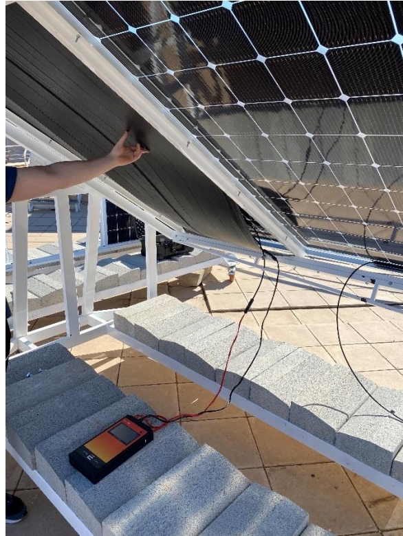
Figura 12. Utilización de plancha negra maleable a medida para ocultar una cara del módulo durante la caracterización.
