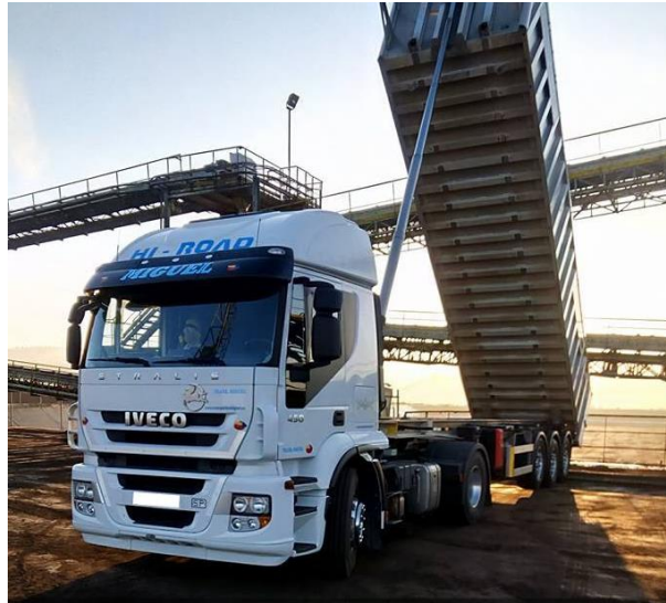
Ilustración 5: camión basculante para alperujo. Fuente: transportesmiguel.es
