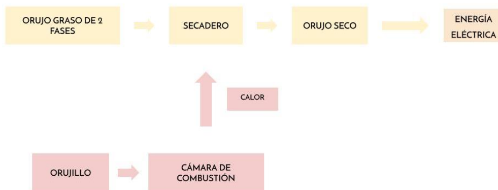
Ilustración 3: Proceso de valorización energética del alperujo. Elaboración propia.
