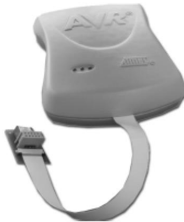
Imagen 9. Programador/depurador JTAG-ICE mk1.
