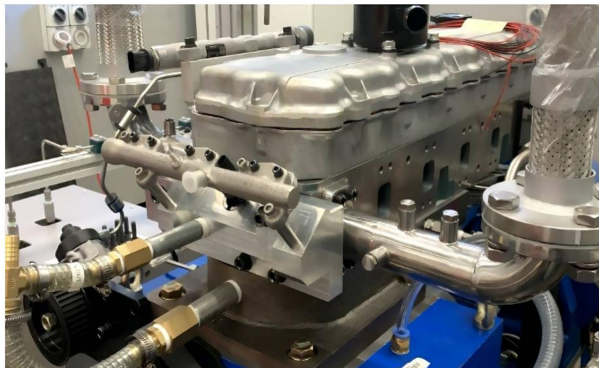
Figura 25 Imagen del motor diésel modificado para consumir un 90% de hidrógeno. Fuente: (Fisher M., 2020).
