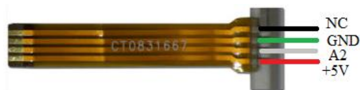
Figura 7.2.7. Configuración pantalla para lectura eje Y
