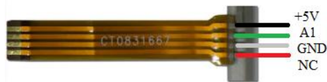
Figura 7.2.6. Configuración pantalla para lectura eje X
