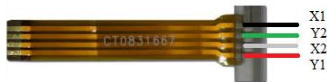
Figura 7.2.5. Nomenclatura de los 4 hilos de la pantalla táctil.
