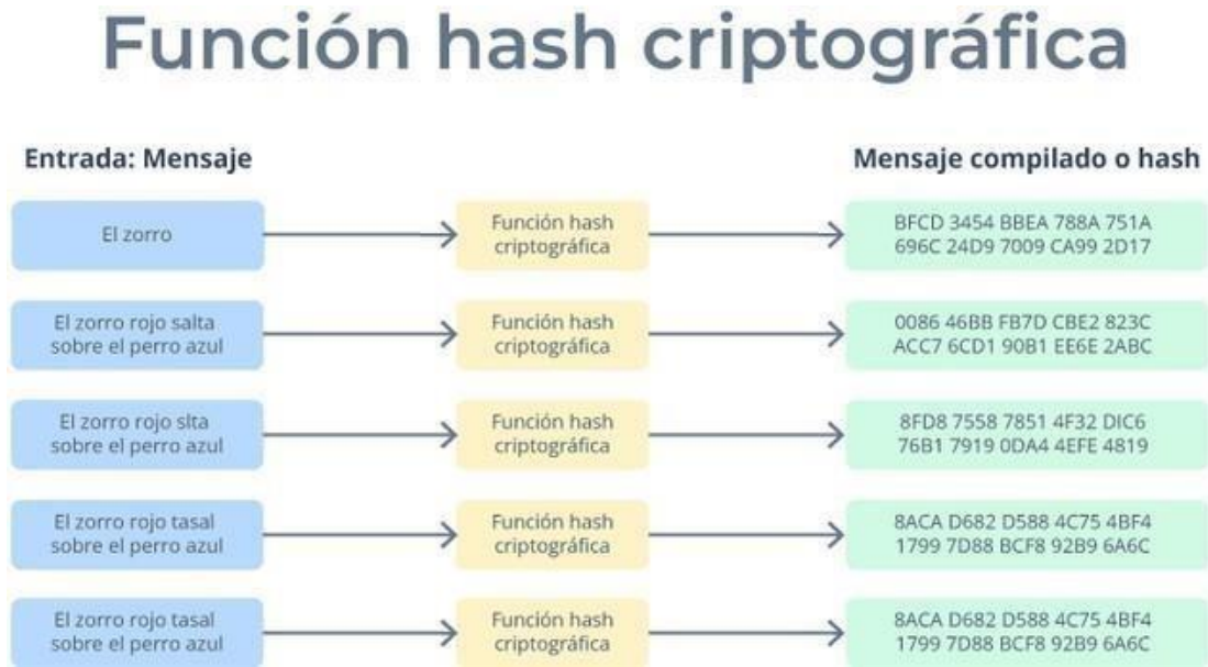
Figura 53: Diagrama de funcionamiento sobre la función Hash criptográfica
