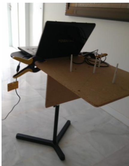
Figura 4.6 . Prototipo multisensor con 4 antenas WiFi
