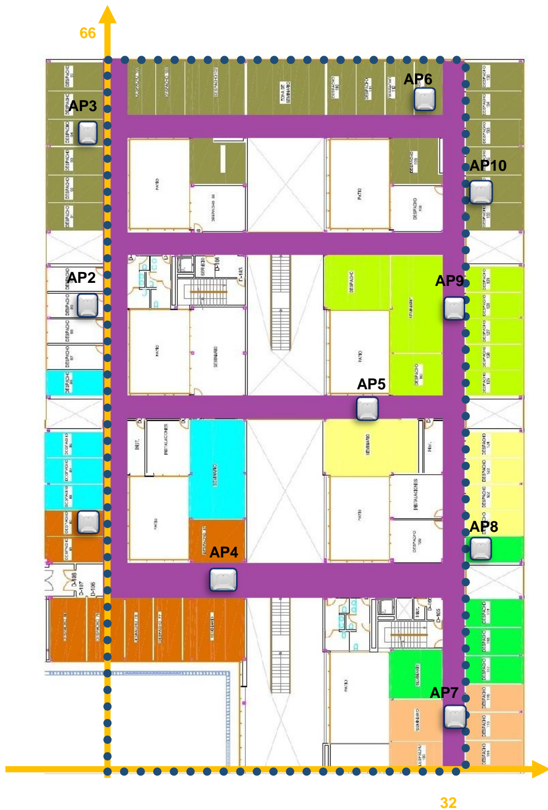
Figura 4.7 . Configuración final del área de calibración con puntos de acceso
