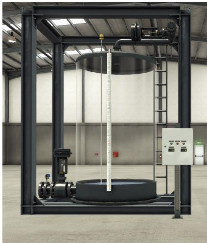
Figura 2.67. Estación de llenado de un tanque.
