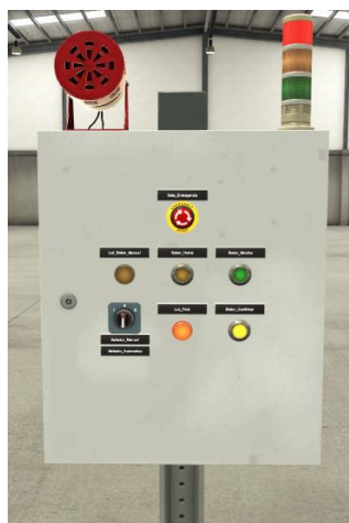
Figura 3.33. Estación modos de trabajo.
