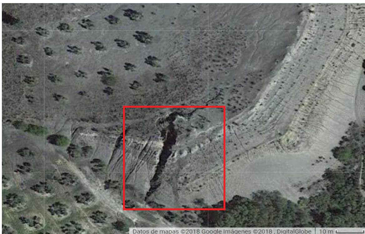
Figura 24. Escombrera con cárcavas en el lado sur-oeste.
