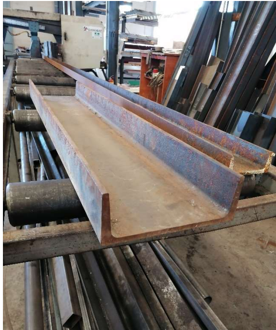
Figura 5.36. Imagen de un perfil UPN 240.
