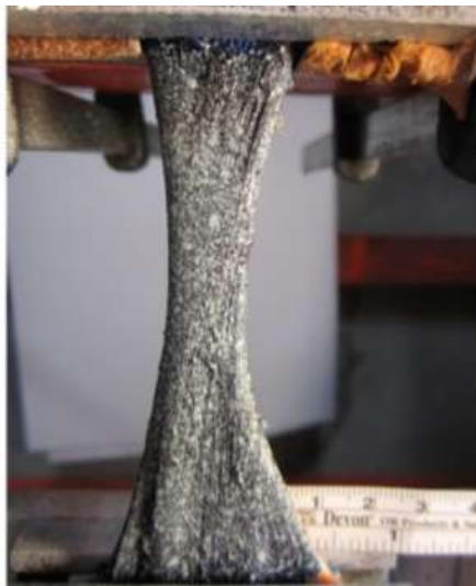
Figura 5.41. Patrón de puntos o speckle [65].
