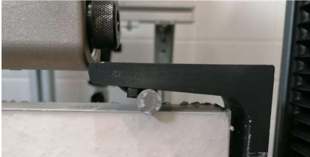
Figura 5.49. Detalle de posición de un rodillo de distribución de carga.
