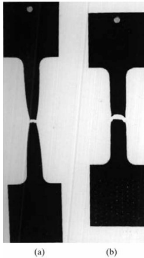
Figura 2.11. Comportamiento mecánico del a) aluminio (dúctil) y b) magnesio (frágil) tras someter a las probetas a un ensayo de tracción [24].
