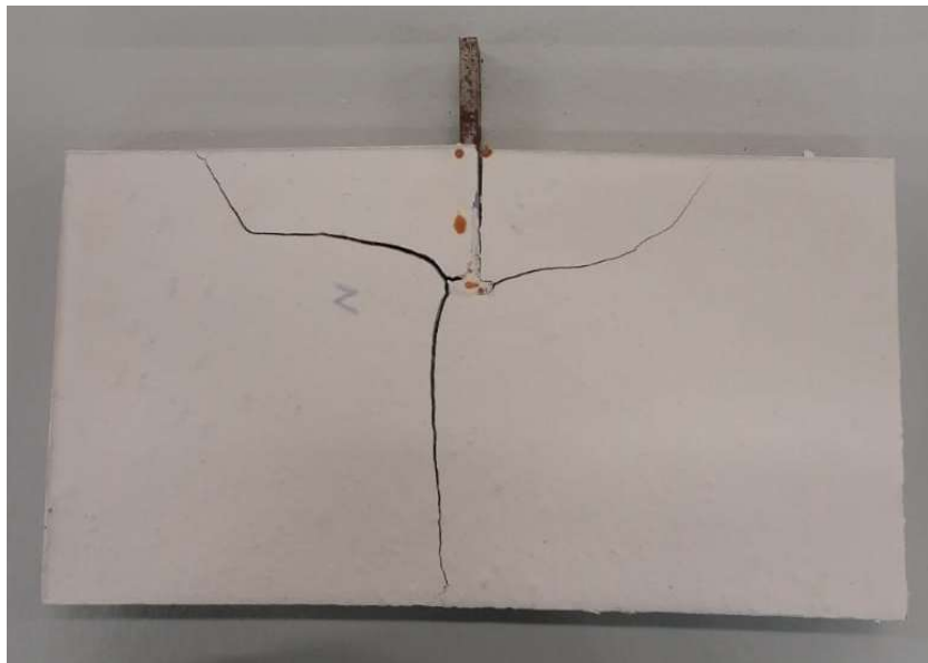
Figura 6.13. Patrón de fractura en probeta de yeso con fibras NFU.
