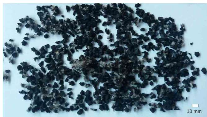
Figura 3.4. Fibras de caucho procedentes de NFU [8].
