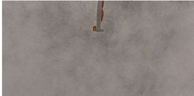
Figura 5.44. Patrón speckle aplicado a una probeta.
