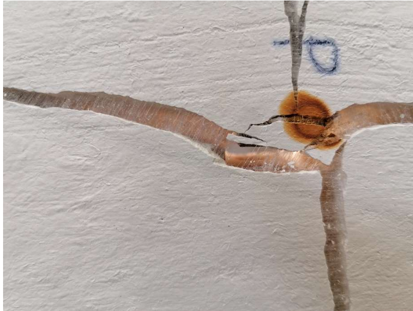
Figura 6.3. Fibras de refuerzo actuando sobre material fracturado en probeta de yeso con fibras de PP
