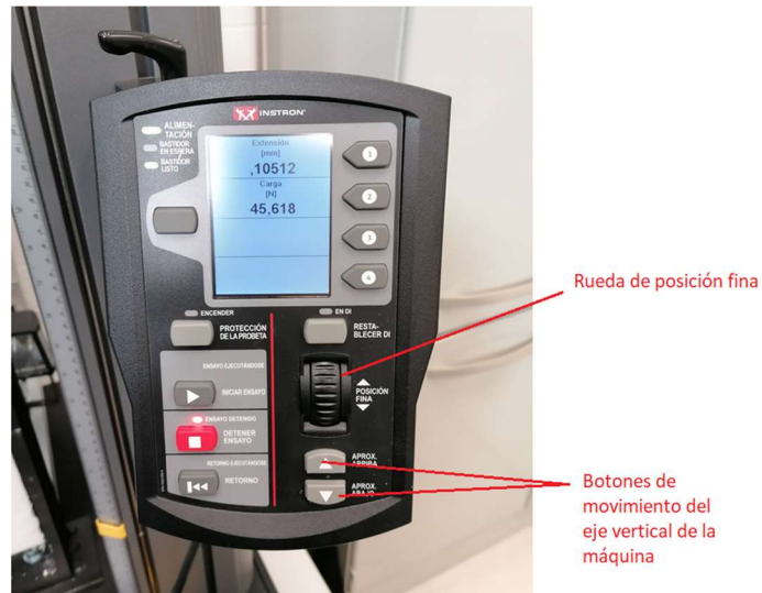
Figura 5.50. Panel de control manual de la máquina.
