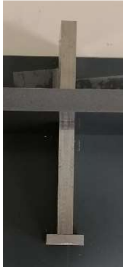
Figura 5.16. Aspecto final de la T fabricada en acero al carbono.
