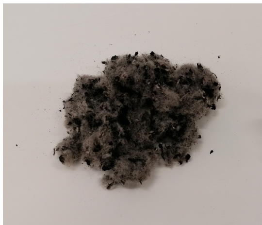
Figura 5.6. Fibras textiles obtenidas del procesado de NFU.
