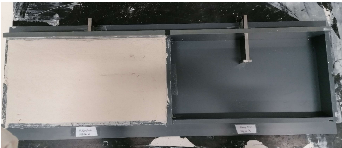
Figura 5.24. Detalle del molde con una cavidad ocupada por una probeta de yeso con fibras de polipropileno fraguando y la otra cavidad vacía.
