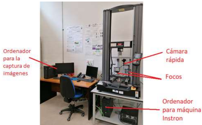
Figura 5.46. Conjunto de la máquina Instron y el sistema DIC.
