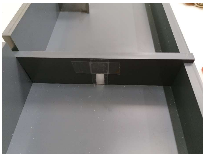
Figura 5.23. Sellado de ranuras del molde con cinta adhesiva.
